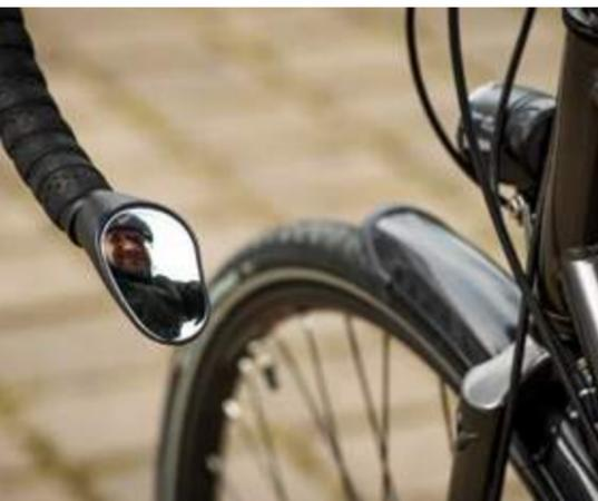
Sprintechs Racing ist ein Spiegel speziell für Rennrad-Lenker. Das Sichtfeld ist recht klein, der Spiegel liegt zudem tief, fast auf Kniehöhe. Um so einen Blick nach hinten werfen zu können, muss der Kopf weit nach unten gedreht werden. Der vorausfahrende Verkehr ist dann kaum noch im eigenen Blickfeld. Durch die Wölbung des Spiegels ergibt sich dann aber eine breite Spiegelung.
