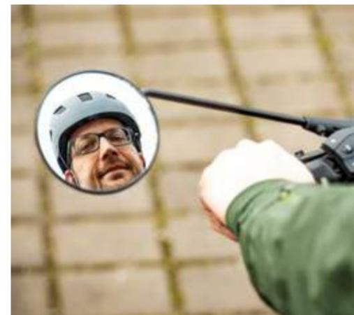
Mit einem großen, kreisrunden Spiegel aus echtem Glas kommt der Krampe KF1 daher. Durch seine Aufhängung ist er sowohl rechts als auch links, an geraden und gekrümmten Lenkern verwendbar. Der schwerste Spiegel im Test lässt sich leicht einklappen, was den Radtransport erleichtert. Durch den langen Arm lässt sich der Spiegel sehr individuell einstellen, hängt hoch über dem Lenker und gibt so schnell
