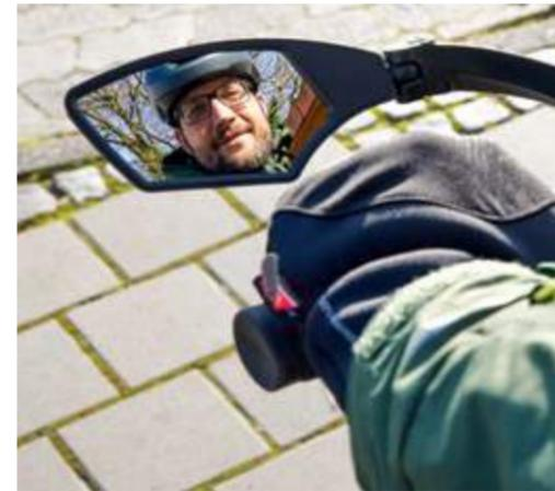
Der M-Wave Spy Space ist schnittig designt und robust. Das fünfeckige Glas ist laut M-Wave bruchstabil, blendfrei und entspiegelt. Trotz des Montagearms ist der Spiegel auf Asphalt wackelfrei. Auch auf Pflaster und Schotter wird das Spiegelbild kaum verzerrt. Denn nach dem korrekten Ausrichten lässt sich der Spiegel mithilfe einer 5-Millimeter-Innensechskantschraube feststellen.
