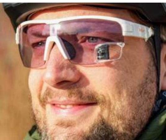
Trieye – das dritte Auge – nennt das norwegische Start-up seine Rückspiegelbrille. Im Brillenglas ist ein fingernagelgroßer, schwenkbarer Spiegel angebracht, der trotz der winzigen Dimensionen einen brauchbaren Blick nach hinten zulässt. Der Spiegel ist an einem Kugelgelenk angebracht, lässt sich so individuell ausrichten. Das Benutzen erfordert viel Übung, denn nicht der gesamte Kopf, sondern nur die Augen bewe-
