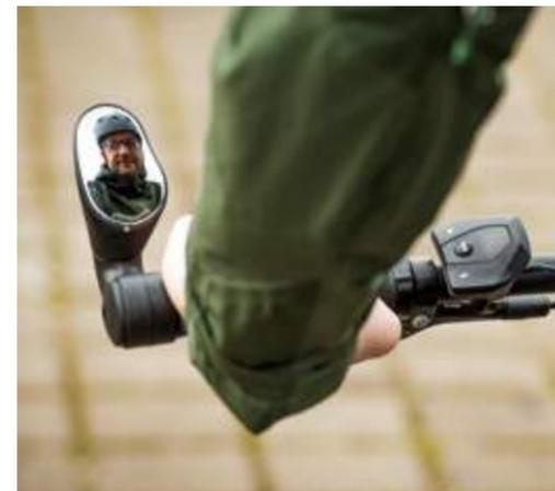
Der Sprintech City ist ein kleiner, unscheinbarer Rückspiegel, der direkt am Lenkerende montiert wird. Geeignet ist er für alle geraden Lenker. Das Sichtfeld ist recht klein und liegt sehr weit unten, sodass der Fahrer seinen Kopf weit drehen muss. Dadurch wendet er seinen Blick etwas vom vorausfahrenden Verkehr ab. Durch die lenkernahe Montage ist der Spiegel sehr stabil, fast völlig wackelfrei. Wegen der gewölbten Spie-
