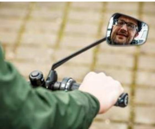
Sehr leicht ist der Zéfal Espion Z56. Er besteht komplett aus Kunststoff. Deshalb ist das große Sichtfeld bruchstabil, die Spiegelfolie verzerrt aber. Wegen des recht langen Arms ist der Spiegel gut im Blick, der Kopf muss kaum gedreht werden. Da der Espion aber sogar auf Asphalt stark wackelt, muss der Fahrer genau hinsehen, um im Spiegel den rückwärtigen Verkehr gut zu erkennen. Für die Montage sind zwei
