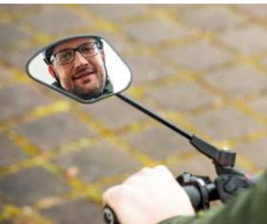
Der Krampe KF Sport ist für alle Fahrräder mit geradem Lenker, insbesondere Trekking- und Crossräder. Der Rückspiegel aus echtem Glas hat ein breites Sichtfeld, die Spiegelung ist frei von Verzerrungen. Beim Fahren auf Schotter und Pflaster wackelt er etwas, auf Asphalt aber ist er sehr stabil. Wegen des recht langen Arms sitzt der Spiegel deutlich über dem Lenker, der Kopf muss kaum gedreht werden, um
